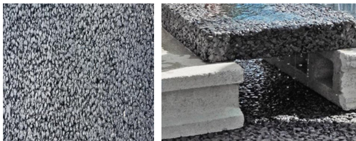
Рисунок 2. Слой асфальтобетона из смесей специального состава, фрагмент покрытия
